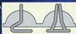
埋着は縦、横に配列
